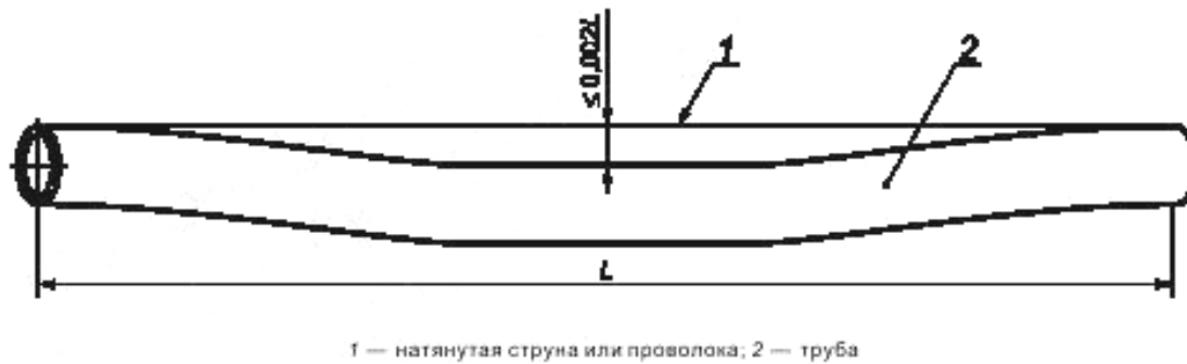
Рисунок В.1 — Измерение отклонения от общей прямолинейности
