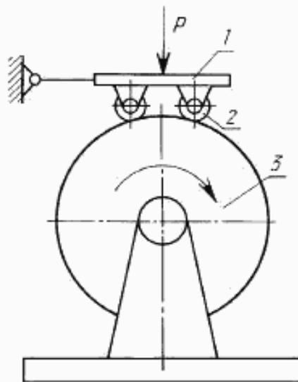
1 — тележка; 2 — испытываемые колеса; 3 — барабан
