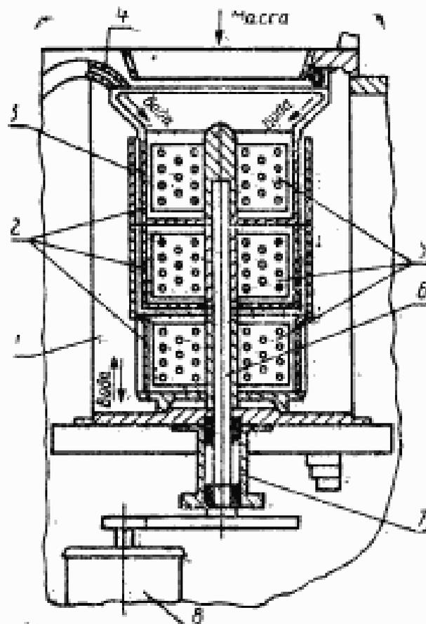
1 — резервуар; 2 — корпус сетки; 3 — втулка дистанционная; 4 — срыски; 5 — лопастные мешалки; 6 — вал; 7 — привод; 8 — электродвигатель.
