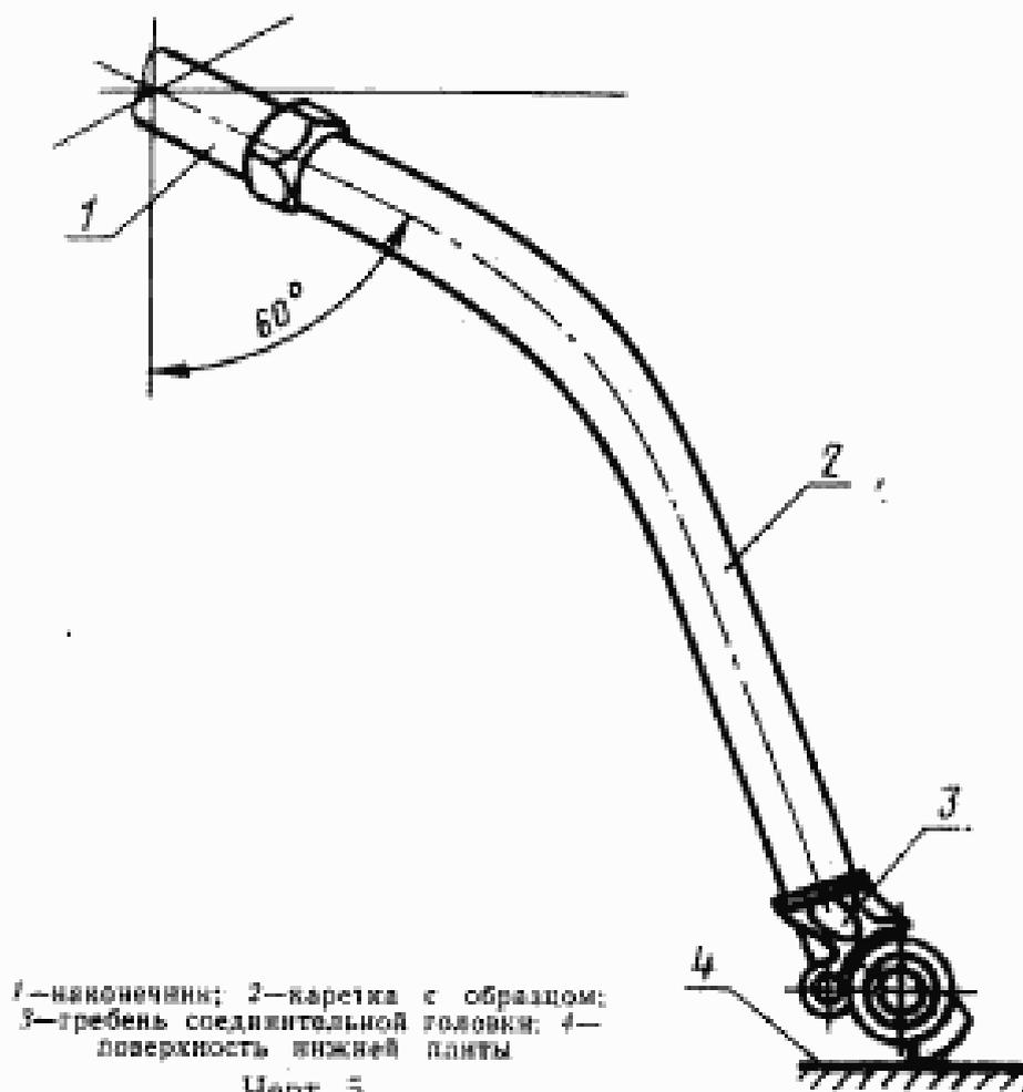
Перед испытанием производят сборку образца рукава с металлической арматурой в соответствии с требованиями ГОСТ 2593—82.
