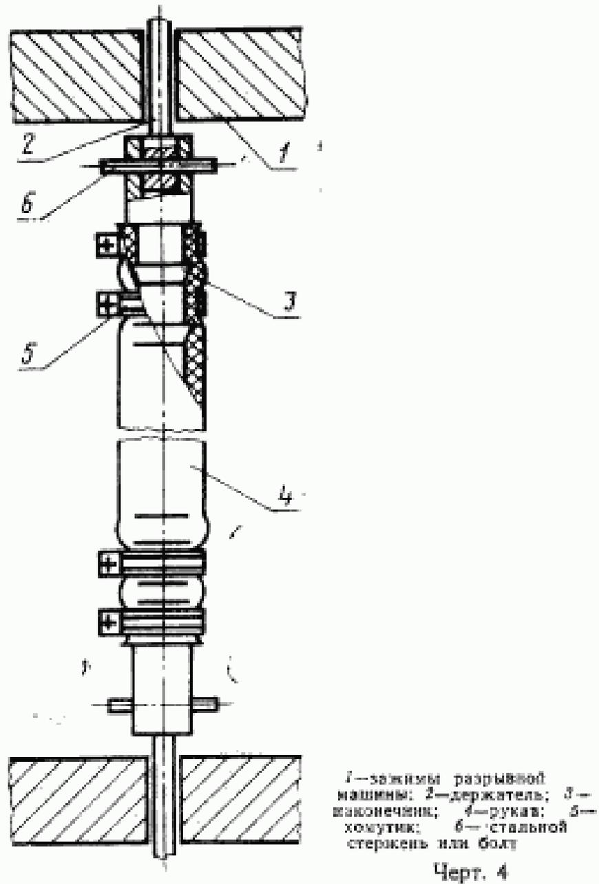
Включают машину и со скоростью  $(48 \pm 2)$  мм/мин проводят растяжение до усилия  $(1000 \pm 100)$  Н  $(100 \pm 10)$  кгс, отмечаемого по шкале силоизмерительного устройства, затем выключают механизм растяжения и измеряют длину рабочего участка.
