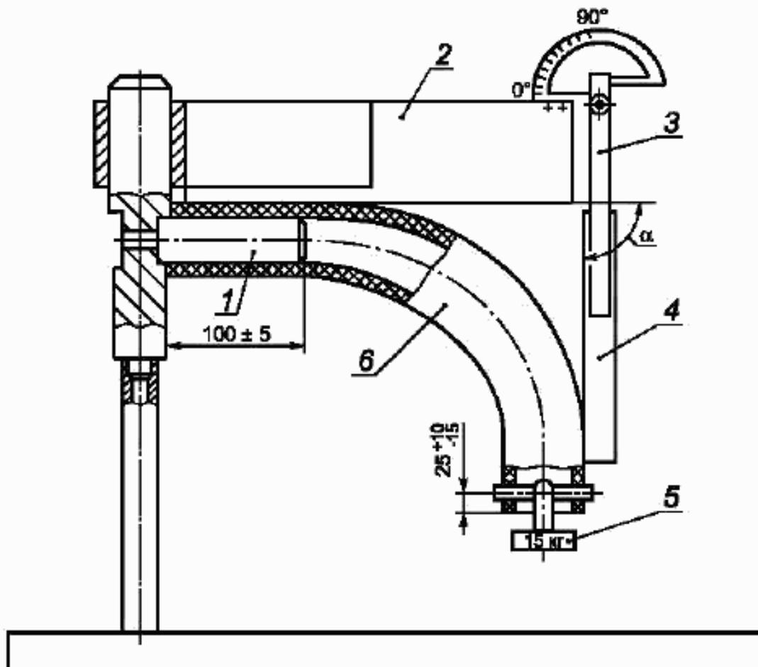
1 — съемный стержень; 2 — приспособление для фиксирования и измерения угла; 3 — угломер типа 4 по ГОСТ 5378—88; 4 — планка для удлинения измерительной поверхности угломера; 5 — груз; 6 — рукав;  $\alpha$  — измеряемый угол  $90^{\circ}_{-5^{\circ}}$ .
