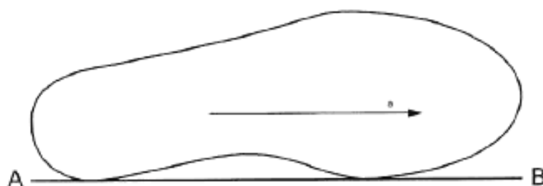
Рисунок 2 — Внутренняя касательная типовой колодки или колодки изготовителя параллельная направлению движения
