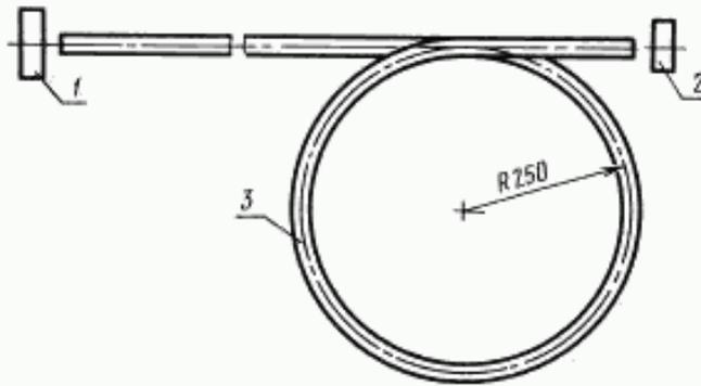
1 — привод; 2 — спидометр; 3 — гибкий вал
