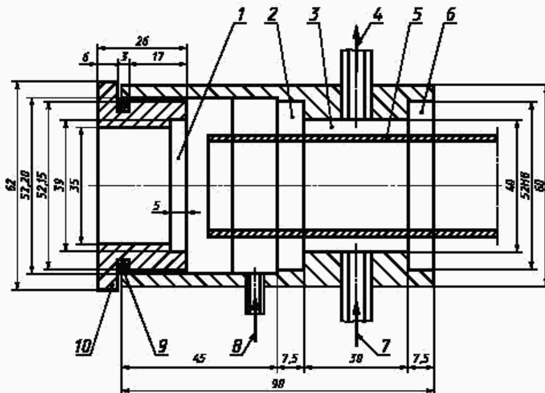
1 — цветное стекло, установленное на эпоксидной смоле; 2 — уплотнительная резиновая прокладка; 3 — водяная камера; 4 — отвод воды; 5 — трубка сжигания; 6 — уплотнительная резиновая прокладка; 7 — подача воды; 8 — подача кислорода; 9 — торцевая прокладка; 10 — втулка с насечкой
