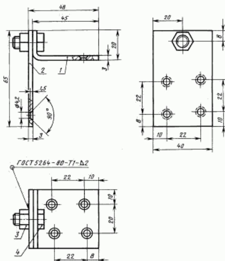
1 — угольник; 2 — пластина; 3 — гайка М8 по ГОСТ 5915—70; 4 — болт М8 × 14 по ГОСТ 7805—70
