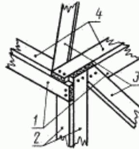
1 — горизонтальные детали торцового и бокового шитов; 2 — стойки; 3 — раскос; 4 — деталь крышки
