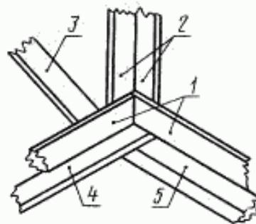
1 — горизонтальные детали торцового и бокового шитов; 2 — стойки; 3 — раскос; 4 — доски пола; 5 — поперечные полозья
