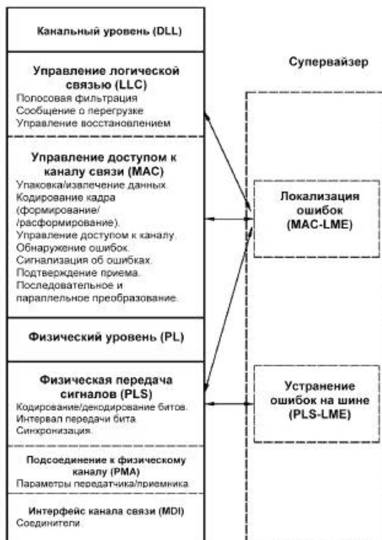
Рисунок 1 — Иерархическая архитектура CAN
