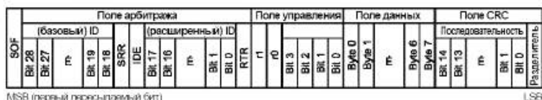
Рисунок 11 — Порядок передачи битов (расширенный формат)
