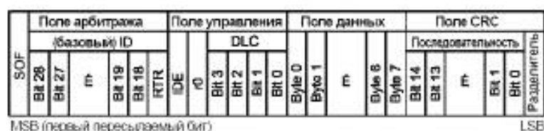
Рисунок 10 — Порядок передачи битов (базовый формат)
