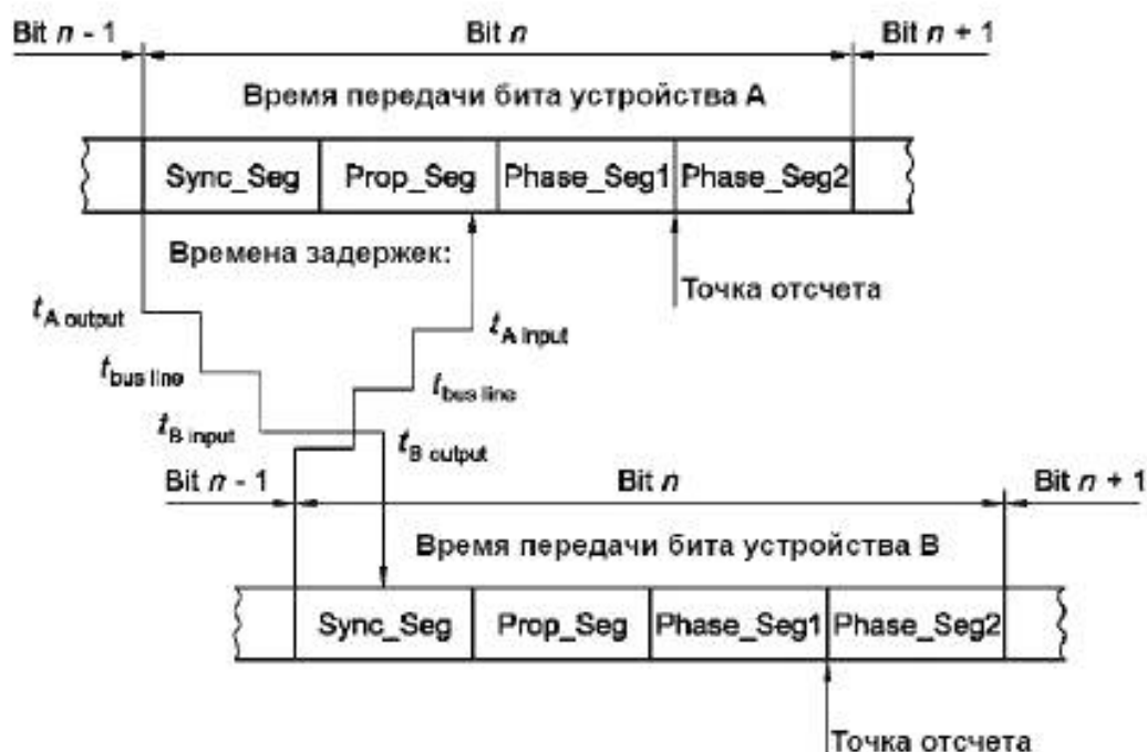
Рисунок 14 — Временные соотношения между временными распределениями узлов CAN A и B во время арбитража, временным распределением двух узлов CAN и временами задержек
