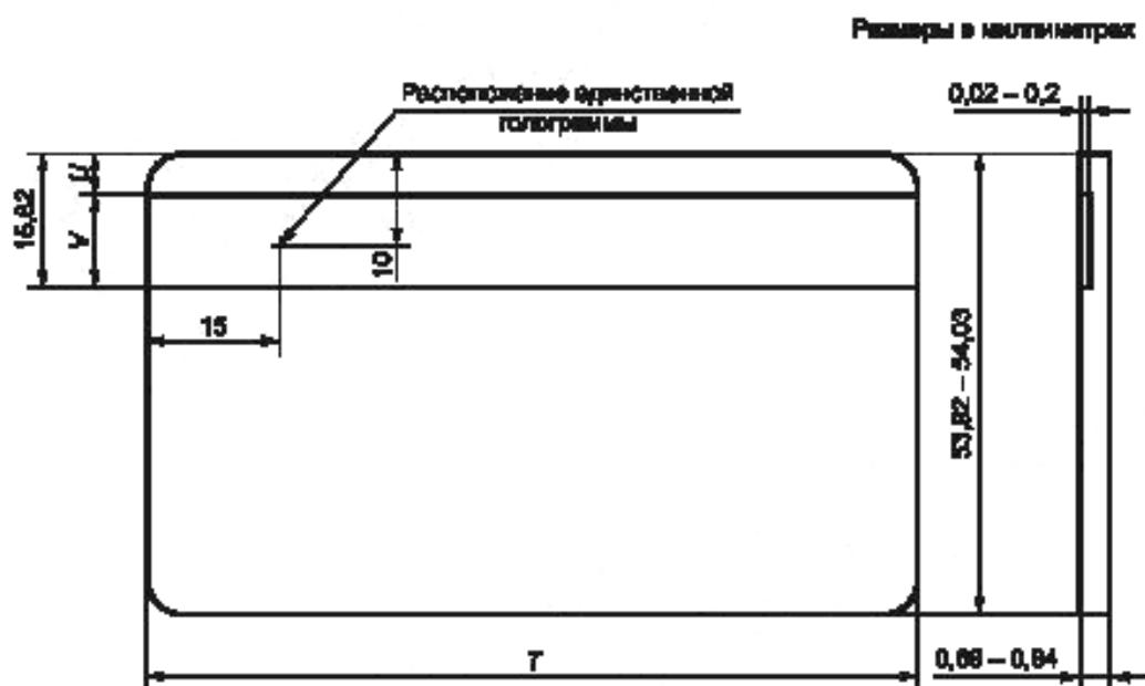
Рисунок 3 — Оптическая зона в виде магнитной полосы
