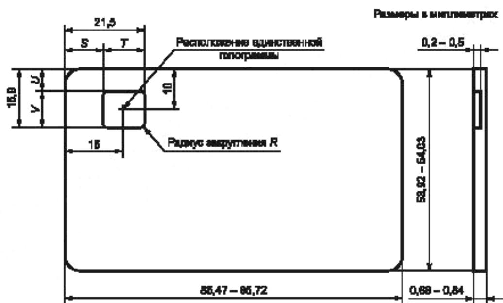
Рисунок 2 — Оптическая зона в виде интегральной схемы
