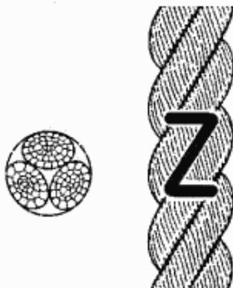
Рисунок 1 — Конфигурация 3-рядного крученого каната (тип А)
