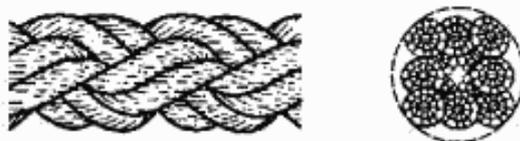
Рисунок 3 — Конфигурация 8-рядного плетеного каната (тип L)
