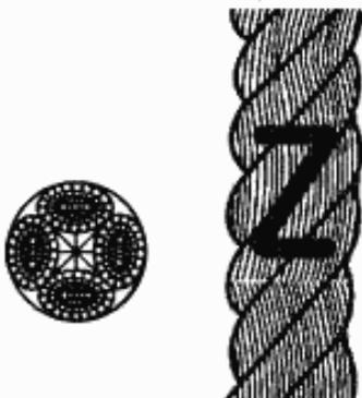
Рисунок 2 — Конфигурация 4-рядного крученого каната (тип В)
