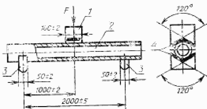
1—деталь, передающая нагрузку; 2—образец; 3—опора; 4—прокладка
