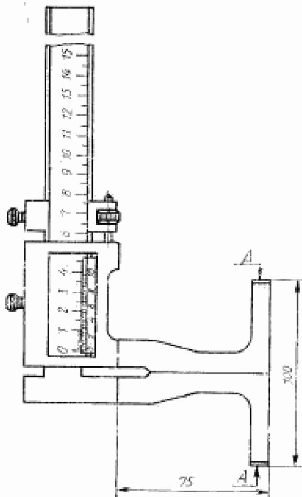
Материал — сталь инструментальная У8...У11 по ГОСТ 1435; поверхность хромирована; твердость поверхностей *A* не менее 59 HRC<sub>a</sub>.
