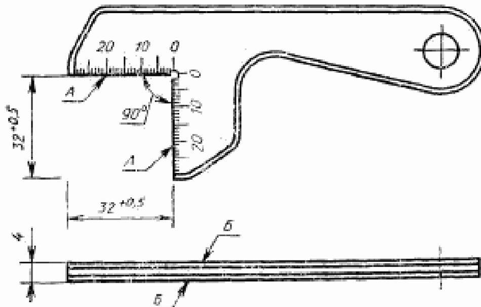
Поверхность хромирована; твердость поверхностей *A* не менее 59 HRC<sub>0</sub>; шкалы нанесены на обе поверхности *B*
