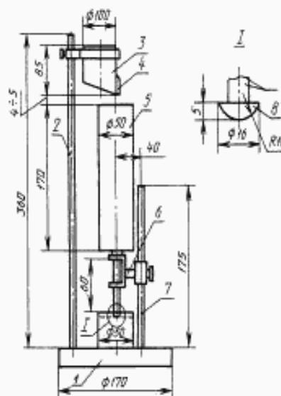
1 — основание прибора; 2 и 7 — штатив; 3 — емкость для груза; 4 — задвижка; 5 — стакан для нагрузки; 6 — направляющая стержня; 8 — стержень с грибовидной насадкой
