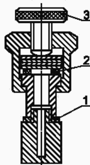
1 — металлическая прокладка; 2 — испытуемый образец; 3 — зажимной винт
