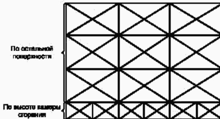
Рисунок 3 — Схема измерения температуры наружной поверхности кожуха
