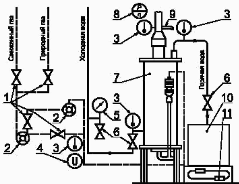
1 — пробковый кран; 2 — газовый счетчик; 3 — термометр; 4 — мановакуумметр; 5 — манометр; 6 — вентиль;
