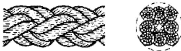
Рисунок 3 – Конфигурация 8-рядного плетеного каната (тип L)
