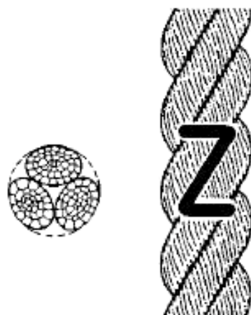
Рисунок 1 – Конфигурация 3-рядного (hauser-laid) каната (тип А)
