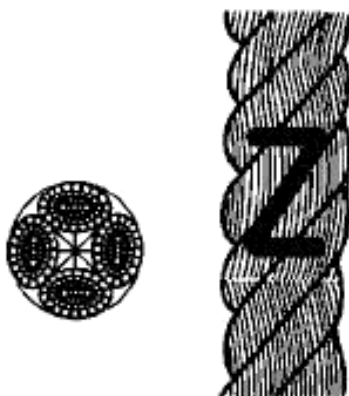
Рисунок 2 – Конфигурация 4-рядного (shroud-laid) каната (тип В)
