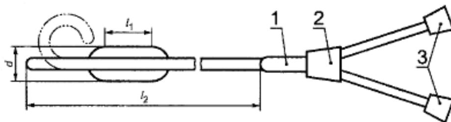
$d$  — диаметр баллона, наполненного воздухом;  $l_1$  — эффективная длина баллона;  $l_2$  — эффективная длина катетера; 1 — противодеформационное армирование катетера; 2 — соединительный узел; 3 — канюля катетера
