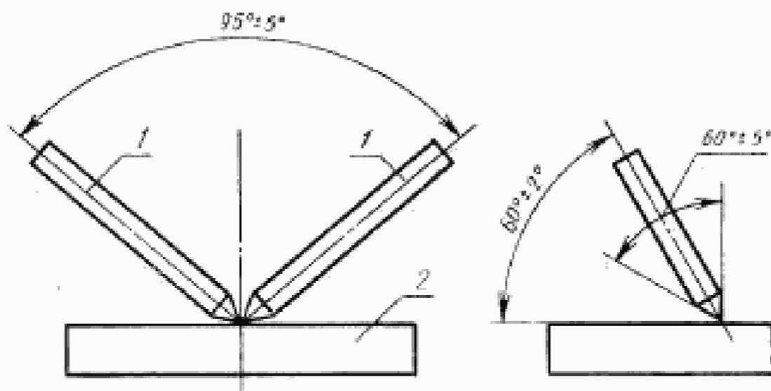
1—электрод; 2—образец испытываемого материала
