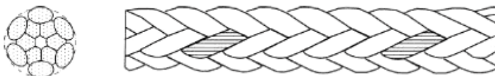
Рисунок 2 — Конфигурация 12-прядного плетеного каната (тип T)
