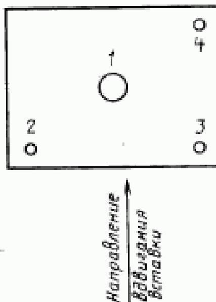
1 — центральный контакт (синхроконтакт); 2 — контакт готовности лампы-вспышки (однократный зарядки); 3 — контакт управления экспозицией (длительность вспышки); 4 — монитор-контакт (контакт, определяющий возможность автоматического управления экспозицией)
