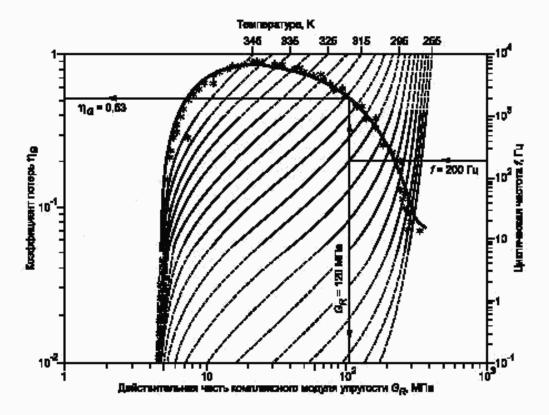
Рисунок 4 — График «перевернутое U» для комплексного модуля упругости
