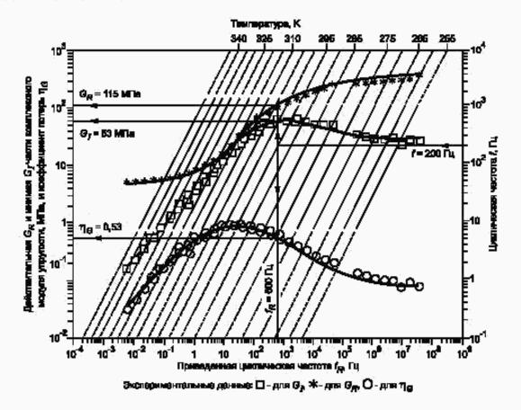
Рисунок 3 — График комплексного модуля упругости для приведенной частоты
